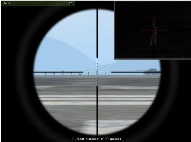
Ciò che appare attraverso un cannocchiale da cecchino con reticolo *Duplex* e dotato di *Mil-Dot*. Si noterà che nell'ottica di figura l'altezza di un uomo a 1000m è compresa fra due "pallini" (*dots*). Di qui la possibilità di rapportare le distanze degli oggetti circostanti alla misura nota del bersaglio. In alto a destra l'inquadratura dello stesso bersaglio a distanza minore, in condizioni criticissime di luce con reticolo illuminato.
